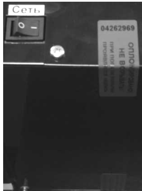
Рис.4. Пломбировка корпуса блока управления
