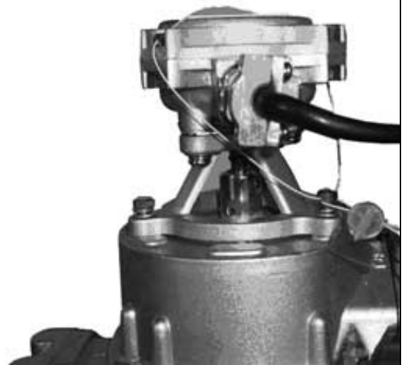
Рис.2. Пломбировка датчика расхода топлива
